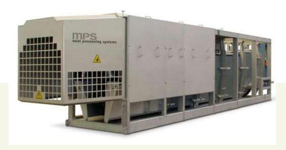
マレル社製自動電気スタニング装置は 肉質に副作用 (悪影響) を与えない最適なスタニングを保証します。この効果的な搬送、スタニング装置は生体に負荷をかけず、食肉技術の重要な点に幅広く配慮がされています。運転費用を低く抑えることができることがこのスタニング装置の特長で、建屋へ大がかりな改造などをせず、簡単に設置できます。
